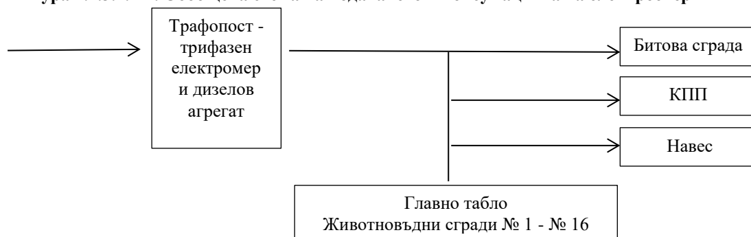
Фигура 2.2.3.2.2-2. Обобщена схема на подаването и консумацията на електроенергия
