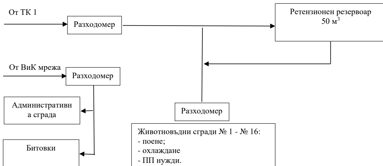
Фигура 2.2.3.2.2-1. Обобщена схема на подаването и консумацията на вода
